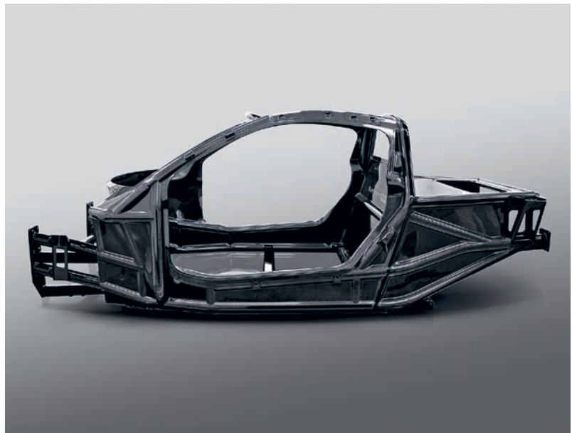
Hightech-Skelett: Ein Chassis pressen die Spezialisten von ELG in unter 100 Sekunden. Die fertigen Autos wiegen später bis zu 60 Prozent weniger als aktuelle Modelle.
