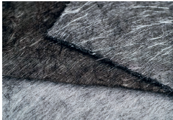
Fest und federleicht: Gefertigt aus Recyclingmaterial, bilden die Karbonmatten von ELG den Werkstoff für das Chassis
